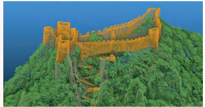
▲ Lidar point cloud of the Puilaurens castle. (Courtesy: L'Avion Jaune)
